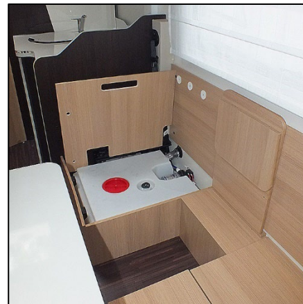
Abb. 128 Frischwassertank in der Längssitzbank (Abb. beispielhaft)
