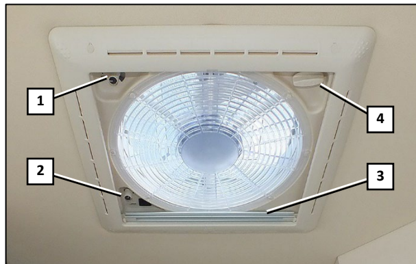
Fig. 85 Ventilateur de toit avec store occultant (exemple)
