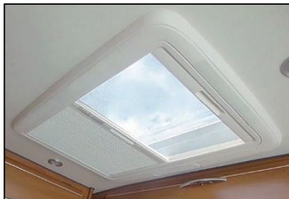
Fig. 90 Store d'occultation du lanterneau (exemple)
