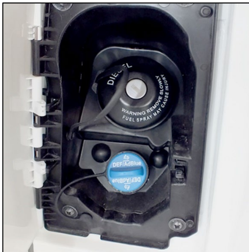
Abb. 7 AdBlue Einfüllöffnung neben der Fahrertür (Abb. beispielhaft)
