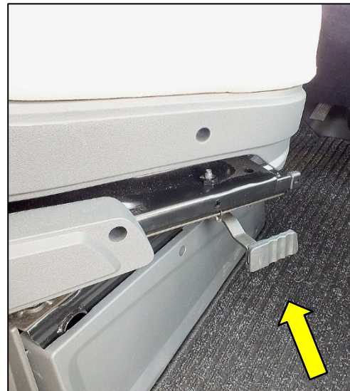
Fig. 11 Levier de blocage du siège conducteur (exemple)
