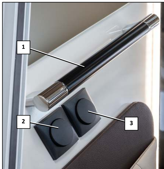
Abb. 20 Lichtschalter neben der Aufbau­tür (Abb. beispielhaft)
