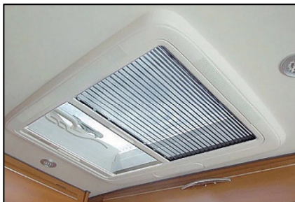
Abb. 91 Insektenschutzrollo an der Dachhaube (Abb. beispielhaft)
