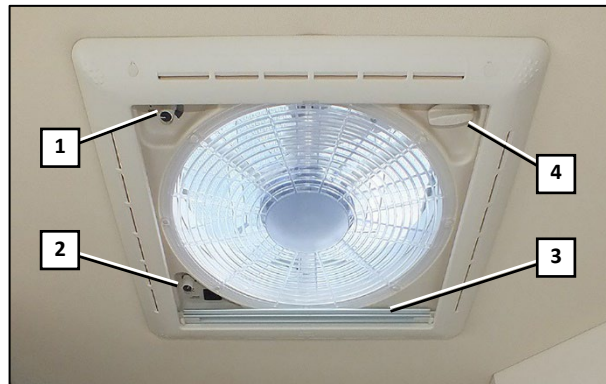
Abb. 85 Dachlüfter mit Verdunkelungsrollo (Abb. beispielhaft)
