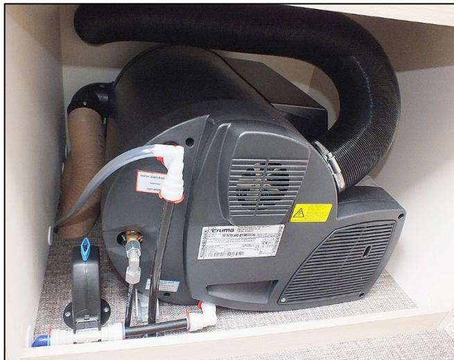
Fig. 104 Chauffage au gaz TRUMA Combi (exemple)
