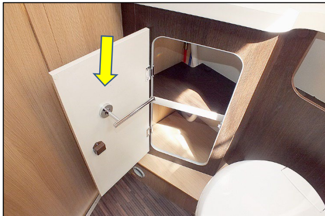
Fig. 66 Porte-rouleau WC côté intérieur de la porte de l'armoire (exemple)
