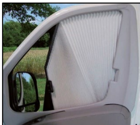
Abb. 94 Seitenverdunkelung (Abb. beispielhaft)
