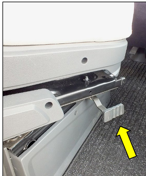
Abb. 11 Arretierhebel am Fahrersitz (Abb. beispielhaft)
