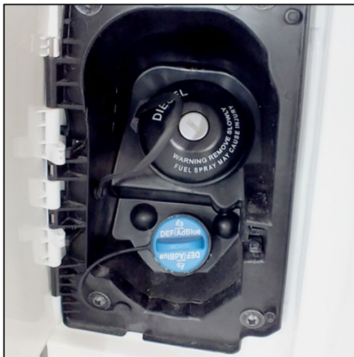
Fig. 7 Bouchon de remplissage pour AdBlue à côté de la porte conducteur (exemple)
