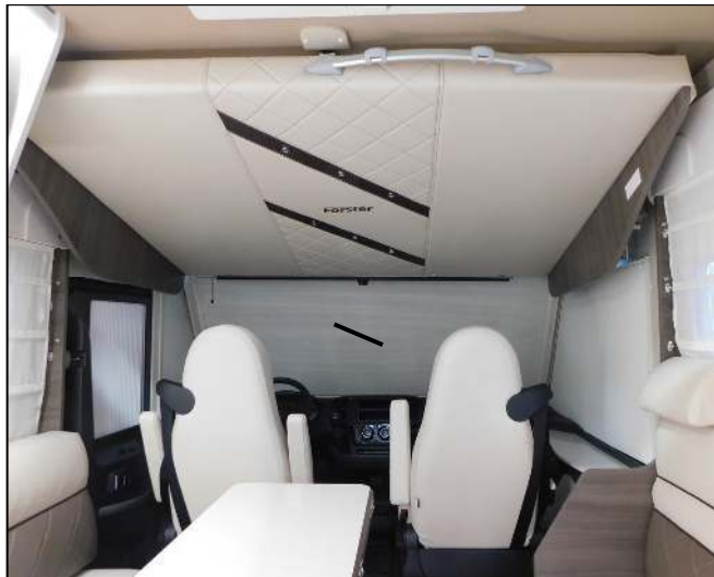
Abb. 40 Hubbett über dem Fahrerhaus (Abb. beispielhaft)
