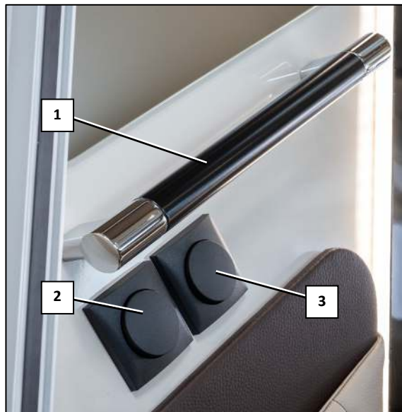
Fig. 20 Interrupteur de lumière à côté de la porte cellule (exemple)
