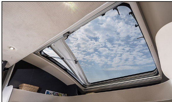
Abb. 86 Panorama-Dachfenster aufstellbar (Abb. beispielhaft)
