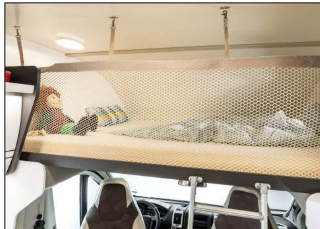
Abb. 45 Sicherungsnetz beim Alkovenbett (Abb. beispielhaft)
