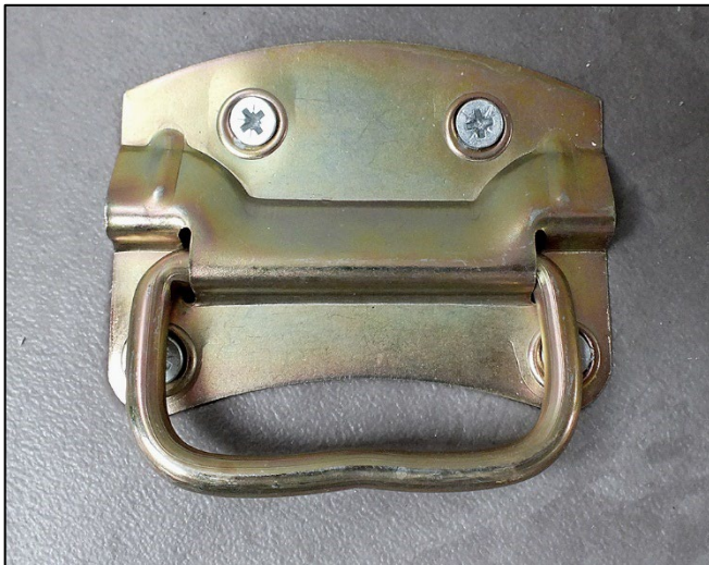
Fig. 59 Anneau d'arrimage dans la soute arrière (exemple)
