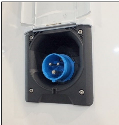
Abb. 96 CEE-Einspeisestecker (230 V) an der Fahrzeugaußenseite (Abb. beispielhaft)
