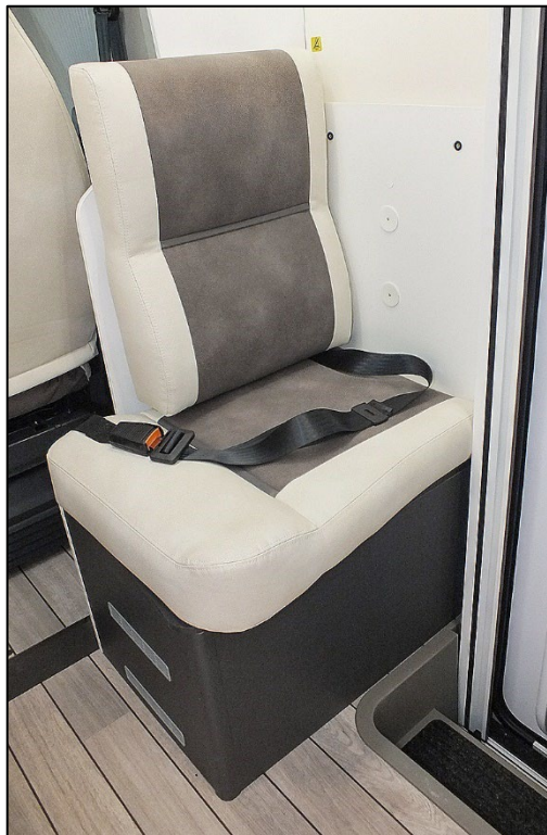
Abb. 77 Einzelsitz rechts nach dem Umbau (Abb. beispielhaft)
