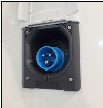
Fig. 96 Adaptateur mâle CEE (230 V) à l'extérieur du véhicule (exemple)
