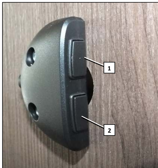
Fig. 43 Interrupteur pour relever le lit central (exemple)
