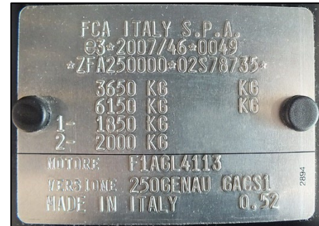
Abb. 3 Fahrzeug-Identifikationsnummer Motorraum (Abb. beispielhaft)
