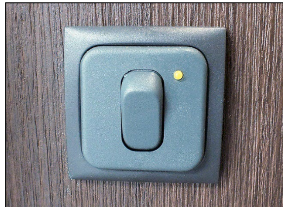
Fig. 140 Interrupteur chauffage du réservoir d'eaux usées (exemple)
