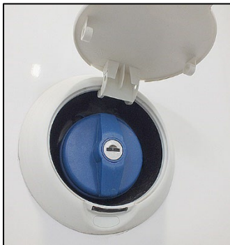
Abb. 129 Einfüllöffnung „Frishwasser“ (Abb. beispielhaft)
