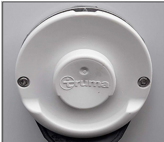
Abb. 103 Abluft-Zuluft-Öffnung der Heizung an der Fahrzeugaußenseite (Abb. beispielhaft)
