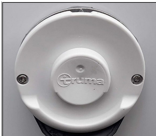
Fig. 103 Orifice d'évacuation/d'arrivée d'air du chauffage à l'extérieur du véhicule (exemple)
