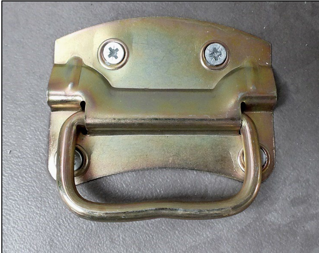
Abb. 59 Zurr-Öse in der Heckgarage (Abb. beispielhaft)
