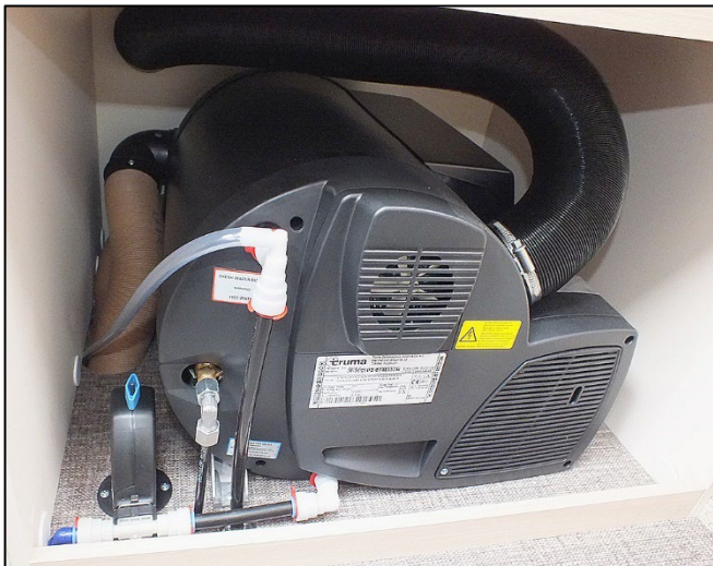
Abb. 104 Gasbetriebene Heizung TRUMA Combi (Abb. beispielhaft)
