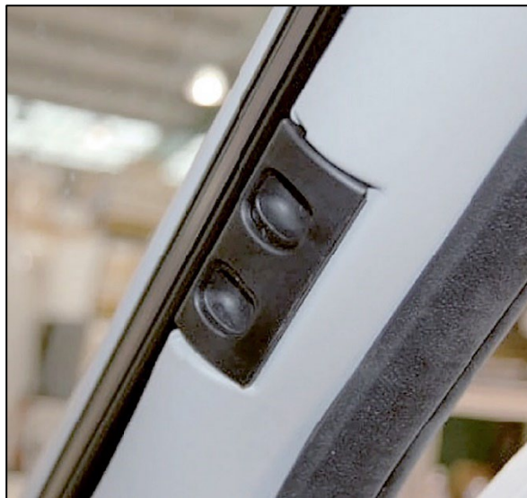
Abb. 92 Griffmulden der Frontscheibenverdunklung (Abb. beispielhaft)
