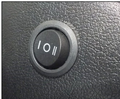
Fig. 27 Interrupteur à 3 positions pour le système multimédia (exemple)
